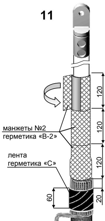
Обернуть усаженную изолирующую трубку тремя манжетами №2 герметика «В-2» последовательно, без зазора, начиная от среза оболочки, на длине 360 мм .
