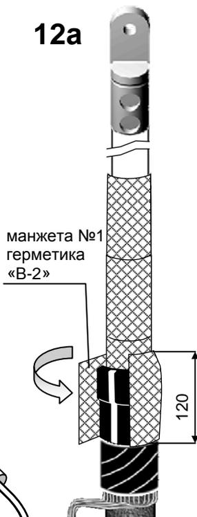
Надвинуть на конец кабеля трубку-экран ТТЭ 90/36 с вывернутым краем по направлению к наконечнику и расположить ее так, чтобы нижний конец трубки закрывал медные проволоки отогнутого экрана на длине 20 мм и упирался в край герметика «С».
