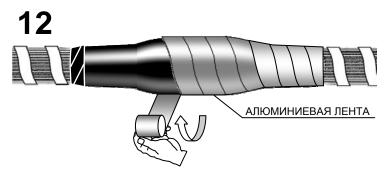
Поверх усаженной трубки ТТИЭ произвести подмотку алюминиевой лентой с перекрытием на 20 мм до упора в медные проволоки экранов кабелей, плотно обжав по всей длине муфты.
