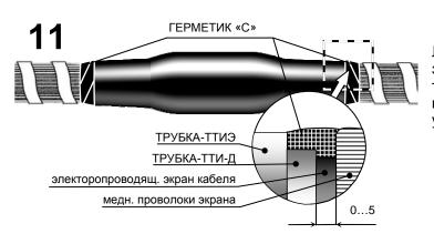
Ленту герметика «С» №1 сложить вдвое по длине и заполнить ей промежуток между усаженными трубками и проволоками экрана Заполнение выполнять с натягом. Лишнюю ленту герметика удалить.
