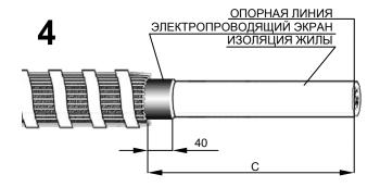
На конец кабеля надвинуть упорную шайбу, продвинув её до среза оболочки и с помощью специального инструмента (роликового ножа) снять электропроводящий экран с жилы кабеля, оставив участок длиной 40 мм у среза оболочки кабеля.
