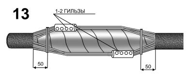
Снять временный бандаж из ленты ПВХ с проволочных экранов. Разогнуть проволоки экранов и расположить их параллельно друг другу по окружности муфты. Зафиксировать проволоки экрана бандажом из медной проволоки на расстоянии 50мм от среза оболочки.
