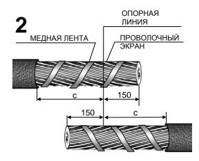
Удалить наружную оболочку с концов кабелей по размерам, указанным на рисунке. Для облегчения снятия оболочки подогреть её пламенем горелки до температуры  $50 \dots 70^{\,0}\,\mathrm{C}$ .
