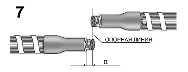
Снять изоляцию с конца каждой жилы соединяемых кабелей снять изоляцию на длине (n).
