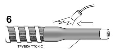
Надвинуть на жилу трубку ТТСК-С стресс-контроля до упора в отогнутые медные проволоки экрана. Усадить трубку, начиная от конца жилы по направлению к проволочному экрану.
