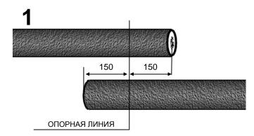
Распрямить концы соединяемых кабелей на длине не менее 1500 мм. Уложить внахлёст в соответствии с указанными в таблице размерами. Отметить опорную линию.
