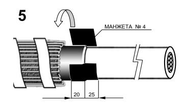
На переход (электропроводящий экранполиэтиленовая изоляция кабеля) наложить манжету № 4 (из комплекта манжет ПСтО) черного цвета длинной стороной по окружности кабеля с заходом на электропроводящий экран на 20мм и на полиэтиленовую изоляцию на 25мм, обжать рукой.
