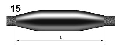
Надвинуть на муфту трубку-защитный кожух (ТТШ-Д), установить её симметрично относительно центра муфты и усадить, начиная с середины, далее в обе стороны.
