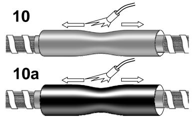
Надвинуть на гильзу изолирующую трубку (ТТИ-Д) так, чтобы она располагалась симметрично на соединительной гильзе. Задиры герметика при надвигании трубки не допускаются. Усадить трубку, начиная с середины, далее в обе стороны.
