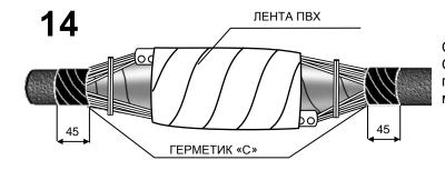
Обмотать место соединения экранов лентой ПВХ. Обезжирить оболочку кабеля и наложить ленту герметика «С» №2, на правой и левой стороне муфты у среза оболочки на длине 45 мм.
