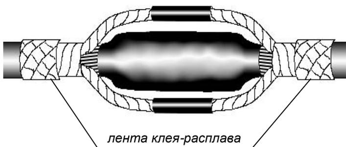
Намотать на металлические оболочки кабеля с бумажной изоляцией и на пластмассовую изоляцию кабеля с пластмассовой изоляцией ленту клея-расплава, не доходя до края брони на расстоянии 50 мм.
