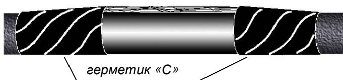
Нанести герметик марки «С» с двух сторон на места паяк и на участки поверхности кабеля, как показано на рисунке для кабеля с бумажной изоляцией и на места крепления пружин – для кабеля с пластмассовой изоляцией.
