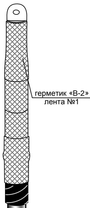
Открытую часть изоляции жилы и цилиндрическую часть наконечника обмотать лентой герметика «В-2».
