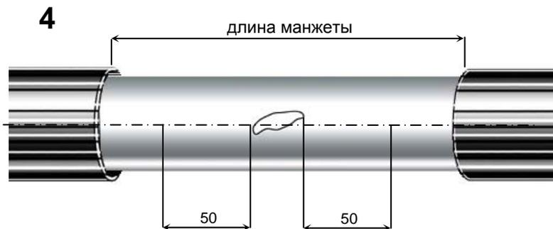
Пластмассовую оболочку, имеющую ребра жесткости удалить на длине равной длине манжеты. Внутреннюю оболочку в месте повреждения по периметру кабеля очистить, обезжирить и обработать (зачистить) на участке длиной не менее 50 мм по обе стороны от места повреждения.
