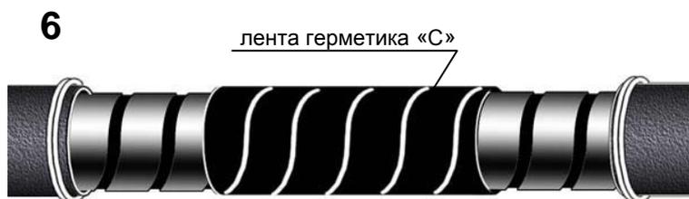
Лентой герметика «С» обмотать подготовленную поверхность оболочки кабеля. Намотку выполнить в один слой с 30%-ным перекрытием.
