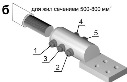
Снять изоляцию с жилы кабеля АВБШнг-1 и АВБШнг-3 на расстоянии, равном внутренней длине цилиндрической части наконечника.
